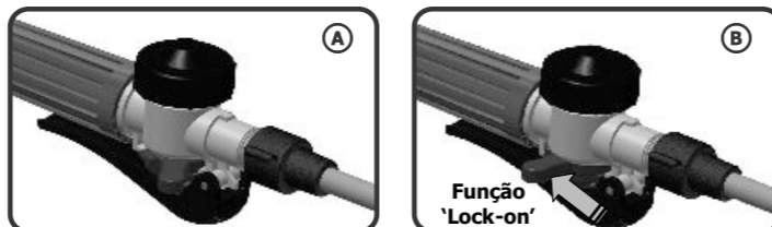
Figura 9 Válvula de descarga: vazão intermitente (A) e vazão contínua (B – lock on)
